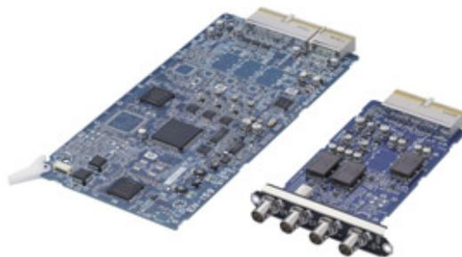
HKCU-1001 можно устанавливать в HDCU-1000 или HDCU-1500; на этой плате имеется два аналоговых композитных выхода стандартной четкости (после
